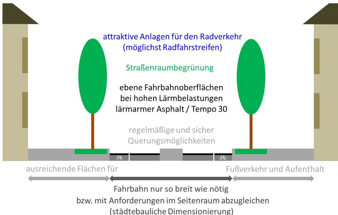
Abb. 14 idealtypischer Straßenquerschnitt im Sinne der Lärmreduzierung
