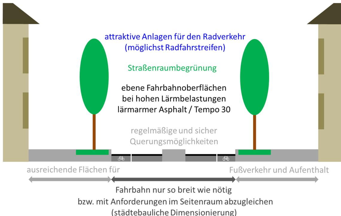
**Abb. 14** idealtypischer Straßenquerschnitt im Sinne der Lärmreduzierung
